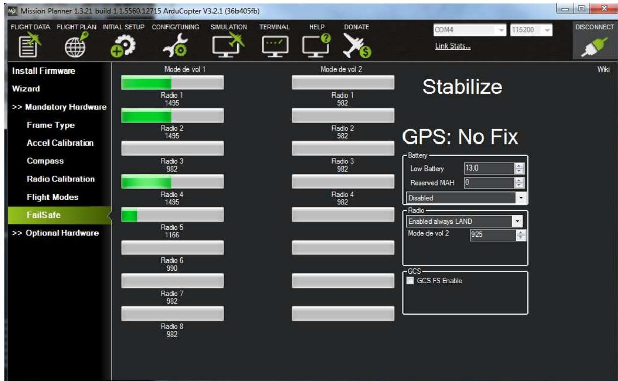
Cette valeur doit se situer dans l'intervalle 925 à 1000 $\mu$ s, être inférieure d'au moins 10 $\mu$ s à la valeur minimale radio allumée et être supérieure d'au moins 10 $\mu$ s à la valeur obtenue radio éteinte.
