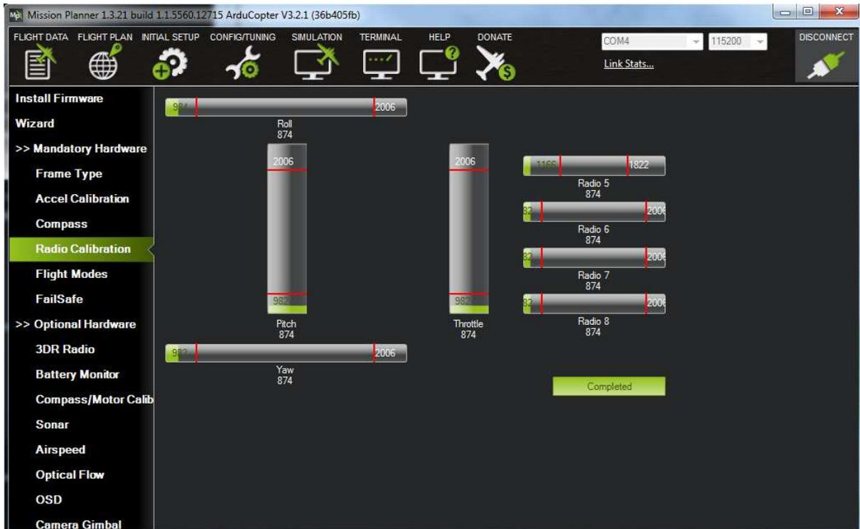
Dans la sous-section « FailSafe » sélectionner le comportement à adopter en cas de perte de liaison avec la radiocommande et renseigner la valeur de détection de la perte de liaison.
