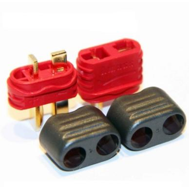
La série des connecteurs XT ont été conçus par la société chinoise AMASS ( <http://en.amassmodel.com> ), elle se décline en 3 principaux modèles, les XT30, les XT60 et les XT90. Le chiffre qui suit la mention XT indique l'ampérage maximum que peut supporter le connecteur.
